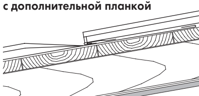
Поперечный шов – простой фальц с дополнительной планкой
