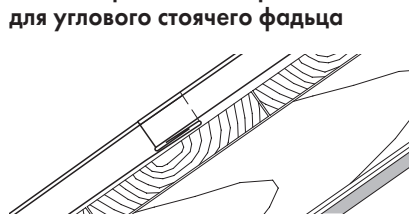
Фальц в фальц – поперечный шов для углового стоячего фальца
