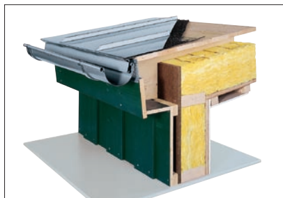
Belüfteter Dachaufbau 2 mit belüftetem Tragwerk, ohne Sparrenvolldämmung und mit strukturierter Trennlage
