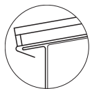
Traufabschluss, stehend gerade (nur für optisch anspruchslöse Anwendungsbereiche)
