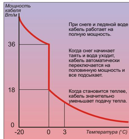
Система управления для G-Trace автоматически измеряет температуру окружающей среды и определяет наличие снега и влаги на кровле. G-Trace система включается и саморегулирующиеся нагревательные кабели начинают работать, когда есть снег или когда имеется влага при низкой температуре, т.е. возникает опасность быстрого образования льда. Следовательно, система гарантирует, что желоба и водосточные трубы всегда будут оставаться свободными от ледяных заторов и сосулек.
